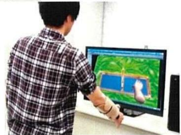
筋電信号によるVR画面内の義手モデルの操作を可能としたヴァーチャル筋電義手訓練システムを開発
