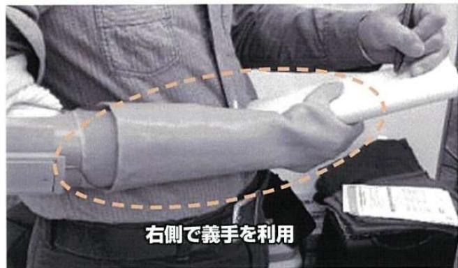
手を欠損した方の両手動作を補助する軽量かつ指の関節が自然に曲がる筋電義手を開発（大学・企業などと共同開発）
