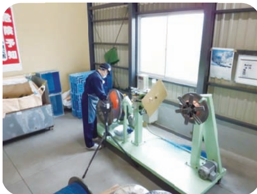
電線剥離作業
