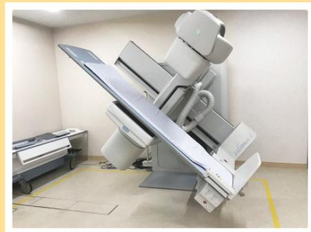
2. 多目的X線TV装置は、フラットパネル型デジタルX線TVシステムです。X線管球と受像部がCアーム型になっており、患者さんが動かなくても、多方向から透視像が観察できます。嚥下造影検査や整形外科検査などあらゆる領域に対応できる装置です。
