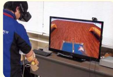
▲開発中のバーチャル筋電義手訓練装置
