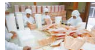
▲スポンジ貼り
