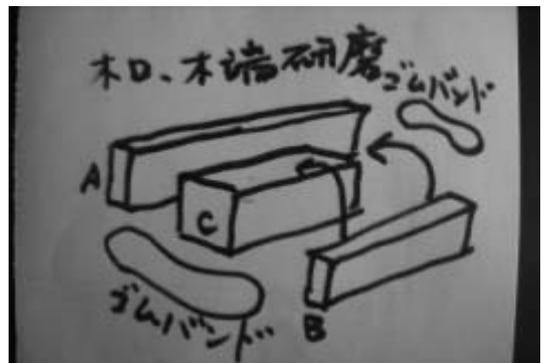
研磨台は100×100×2000ほどの角材を土台にし、研磨材の両端を固定するためのストッパーを取り付ける。一端は固定ストッパーで他端は可動ストッパーで研磨材を固定する。可動ストッパーの土台への固定は先端が少し尖ったボルトか、先端をハンマーで平らに叩いたネジで行う。
